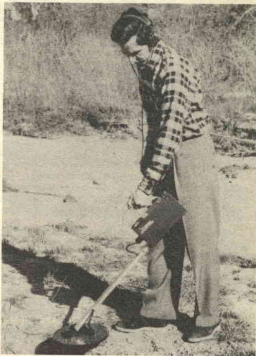
Utilizzazione di un cercametallo ad un transistor, come quello illustrato nel n. 28 di «Fare», leggermente modificato per permettere la ricerca al suolo: per mezzo di un bastone è stata aumentata la distanza tra la bobina esploratrice ed il complesso elettronico
