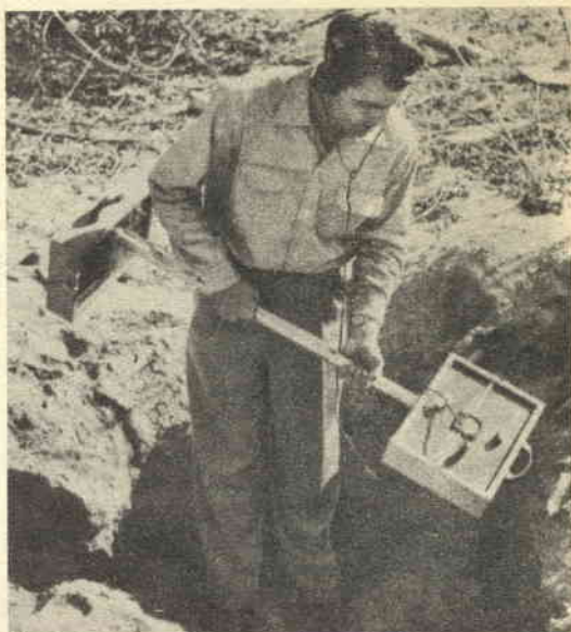
Posizione in cui va tenuto il cercametri a trasmettitore e ricevitore, mentre la ricerca progredisce, ossia mentre lo scavo viene approfondito e la posizione dell'oggetto viene via via puntualizzata
